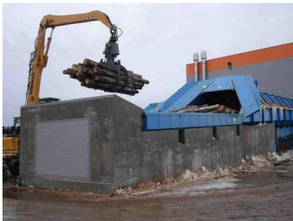
Рисунок 1.3. Подача сырья (древесины) на транспортеры ДПЦ
